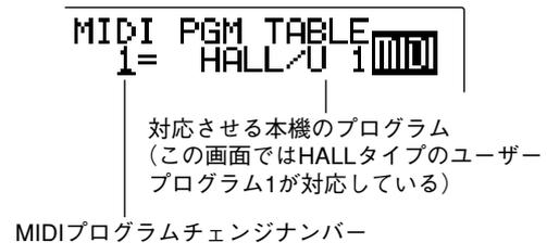
2. PRE DELAYつまみを左右に回してカーソルを移動させ、REV TIMEつまみを左右に回して、MIDIプログラムチェンジナンバーと本機のプログラムとの組み合わせを設定します(128種類の組み合わせを設定できます)。
