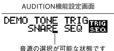
2. PRE DELAYつまみを左右に回してカーソルを移動させ、発音させる音源を選ぶか、発音のタイミングを選ぶかを決めます。
