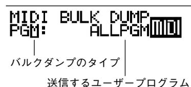
2. REV TIMEつまみを左右に回してバルクダンプのタイプを選びます。
