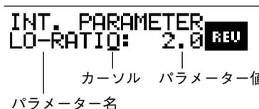
2. PRE DELAYつまみを左に回してカーソルを移動させ、REV TIMEつまみを左右に回してエディットするパラメーターを選びます。
