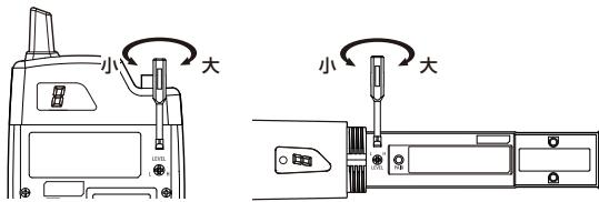
\*操作の際は必ずトランスミッターに付属しているミニドライバーを使用してください。
